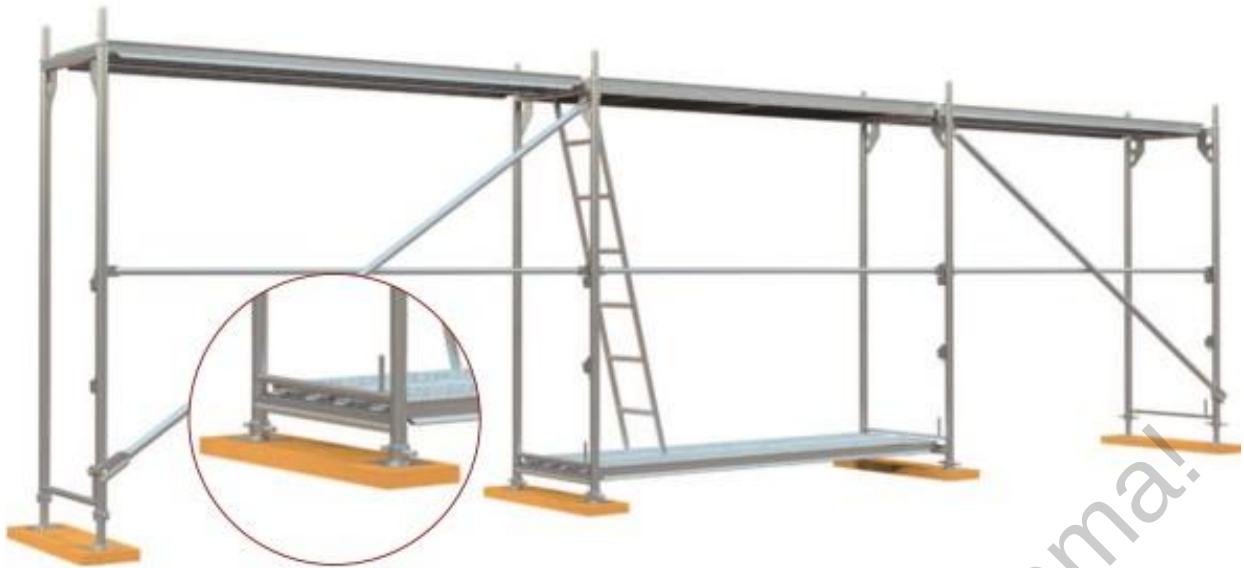
9 pav. Pirminių sijų ir plieninių paklotų naudojimas atremti kopėčias pirmame aukšte
